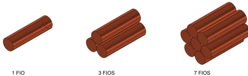
**Figura 1 - Fio e Cabos de Aço Cobreado Nu para Aterramento**
